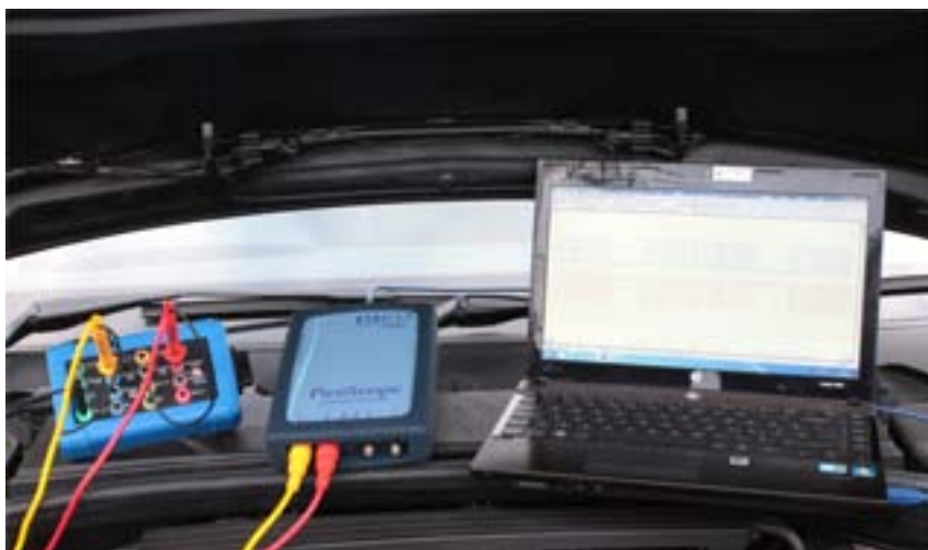
图（17）CAN 测试盒连接示例
