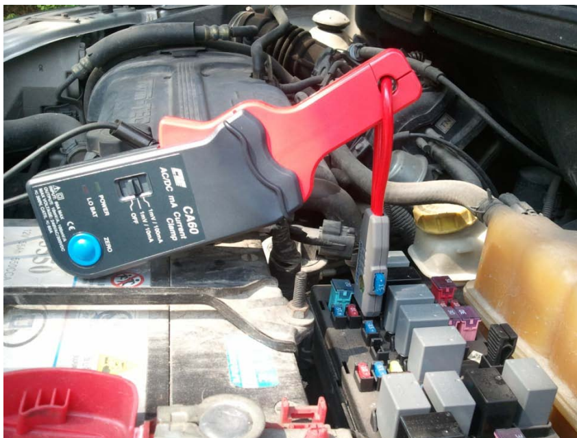
图（14）保险丝延长线连接示例
